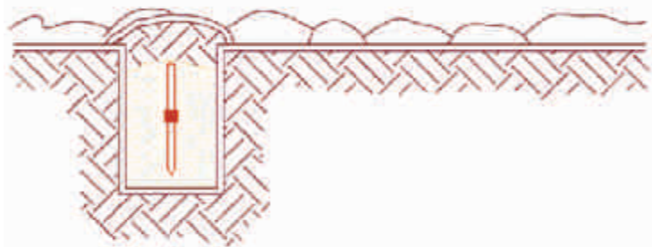
Suelo tratado con Gel mejorador de Resistividad de Suelos (dado el uso de una jabalina profunda o cable).
